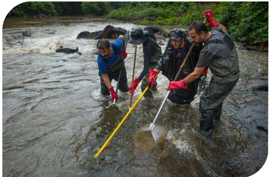
Figure 93 : Les experts d'HYDRECO utilisent la méthode de la pêche électrique en basse conductivité. Cette méthode expérimentale nécessite de porter une combinaison et des gants pour éviter l'électrocution ! ©T. Stoecklé
